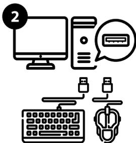
Подключите USB-кабель к свободному USB-порту вашего компьютера. Из-за функции подсветки данное устройство является энергоемким USB-устройством, которое будет работать только при подключении непосредственно к компьютеру или USB-концентратору.
